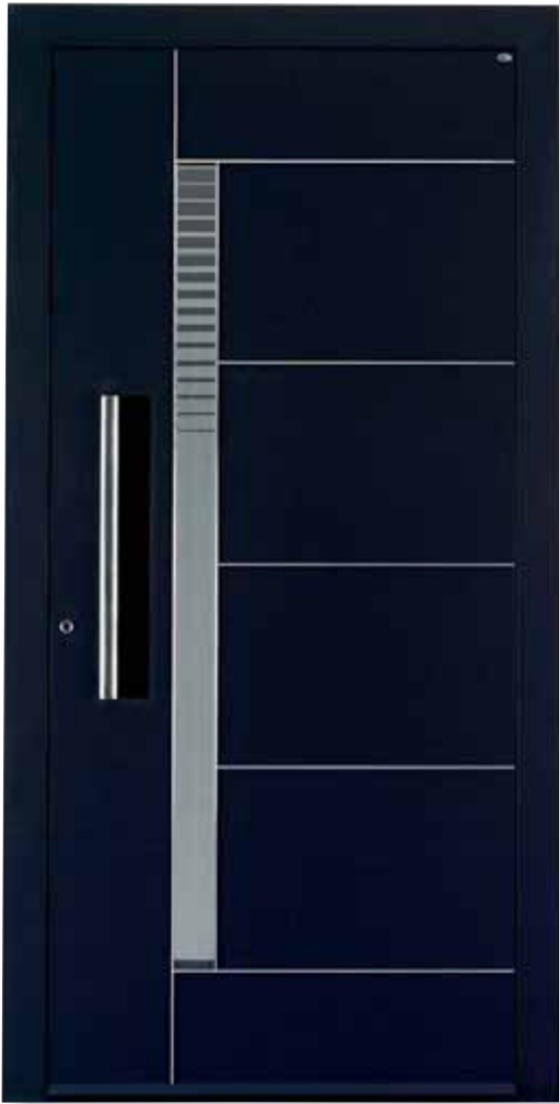
LAEL 340 flügelüberdeckend mit 4 mm Edelstahllisenen Farbe: ST 89 anthrazitgrau Glastyp: 340.7200 Klarglas teilmattiert Querstreifen nach oben klar auslaufend Grifftasche: H 900 (600 mm)
