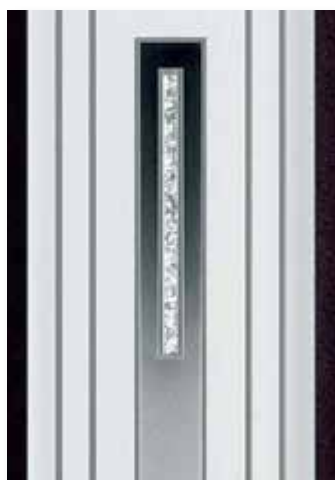
LAEL 588 flügelüberdeckend mit 4 mm Edelstahllisenen Türfarbe: ST 8022 schwarzbraun Glastyp: 588.9030 Klarglas teilmattiert Linien klar, Farveredelung mit Verlauf schwarz und Bruchglasstreifen Griff: SG 116 (1000 mm) Rosette: 10-K-07
